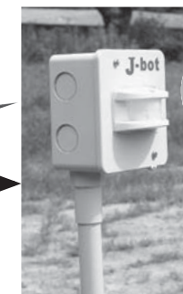
②無線で制御装置に信号が送られる
